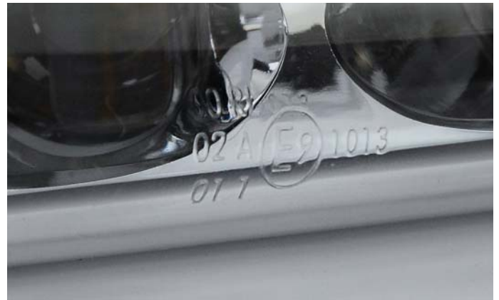
TECHART Qualitätsmerkmale: E-Prüfzeichen und ECE R87 Zulassung für Tagfahrleuchten Signs of TECHART quality: the E-certification and the ECE R87 approval for running lights
