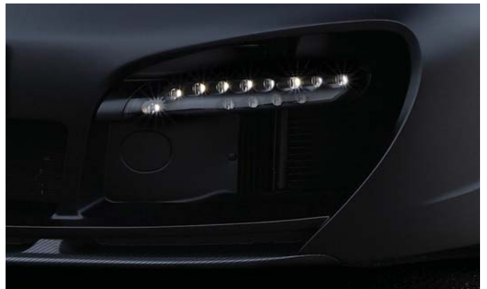
Frontspoiler II GTS mit multifunktionalem Tagfahrlichtsystem in schwarz Front spoiler II GTS with multifunctional daytime running light in black
