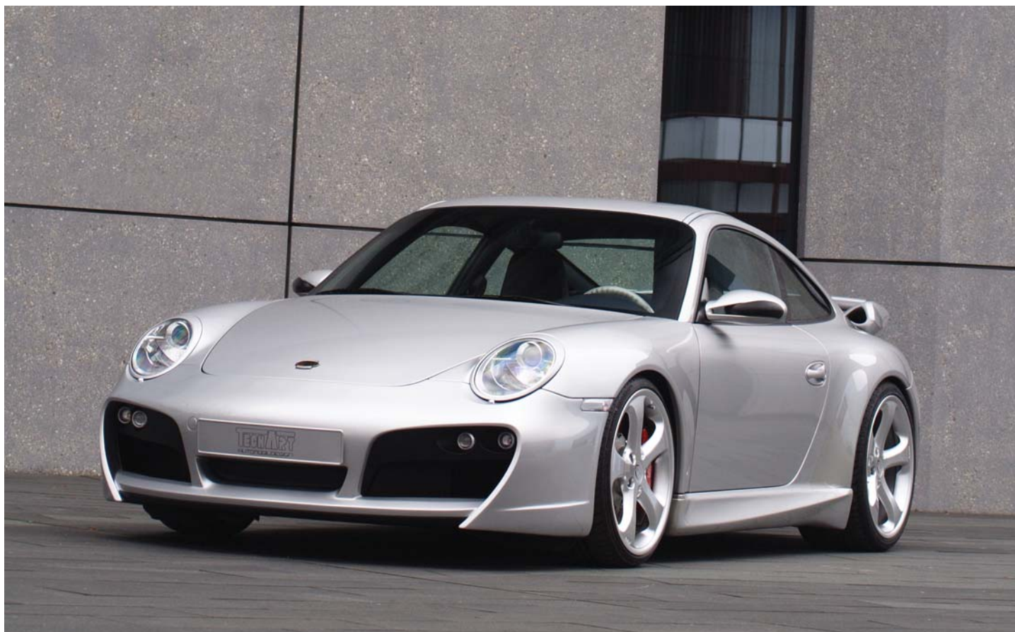
TECHART Coupé bis Modelljahr 2008 mit Frontspoiler II mit Doppelscheinwerferereinheit, Zierblenden für Scheinwerfer, Seitenschweller, Zierblenden für Außenspiegel sowie Heckspoiler II TECHART Coupé up to model year 2008 with front spoiler II with double headlamps unit, headlight trims, side skirts, side mirror trims as well as rear spoiler II
