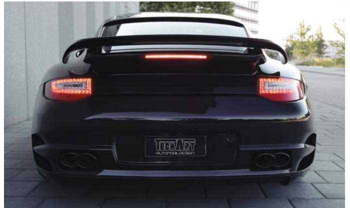
Heckschürze II mit Umbau Kit Heckleuchten auf Modelljahr 2009 Rear apron II with upgrade kit rear lights model year 2009
