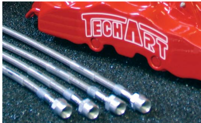
Stahlflex Bremsleitungen und lackierte Bremssättel Steel-flex brake lines and painted calipers
