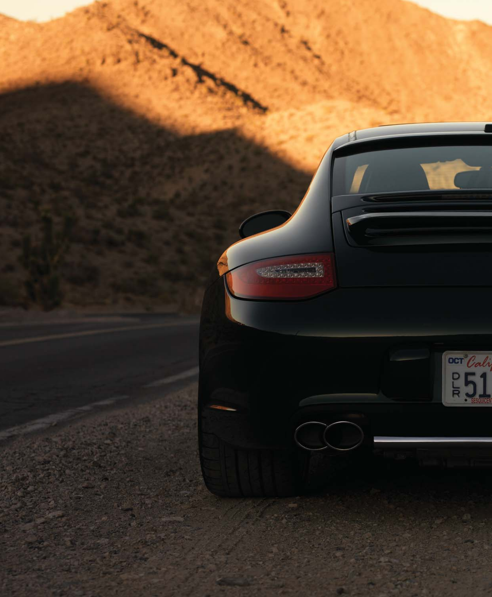
Zweiflutige TECHART Edelstahl Endrohre im Doppeloval Design, kombiniert mit Heckdiffusor in silber.
