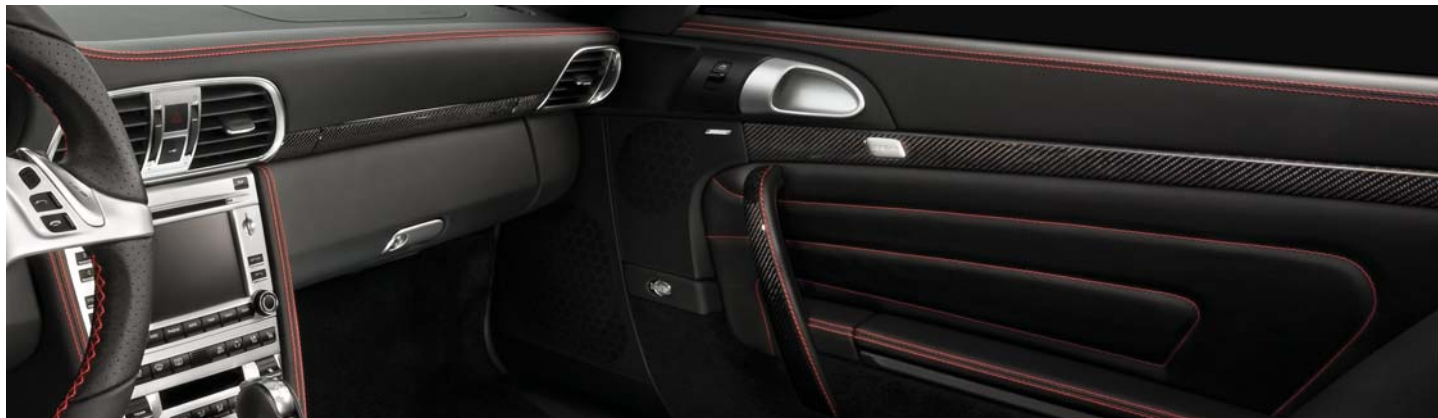
Nachträgliche Akzentuierung vorhandener Ziernähte mit farblich abgesetztem Garn Supplementary enhancement of the existing stitching with contrasted yarn
