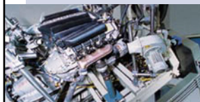
Vollmotoren-Schwenkprüfstände zur Erprobung und Entwicklung des Ölhaushalts (PKW + NFZ)
